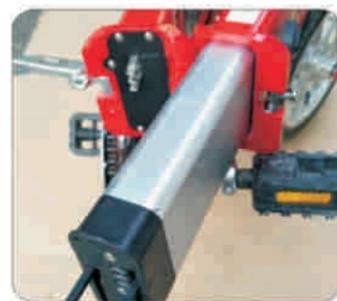
Источником энергии для электромотора служит литиевая аккумуляторная батарея. Возможно использование нескольких режимов работы: помощь в движении при вращении педалей, движение только за счет вращения педалей и движение только от аккумулятора с управлением ручкой газа (как в модели 14". Модель 20" не имеет ручки газа).
